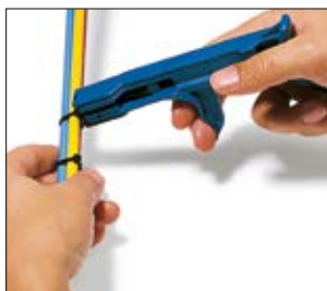
Werkzeug ansetzen, Kabelbinder spannen.
