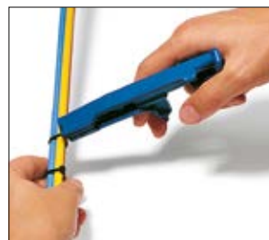
Abschneiden durch Drehen des Werkzeuges.
