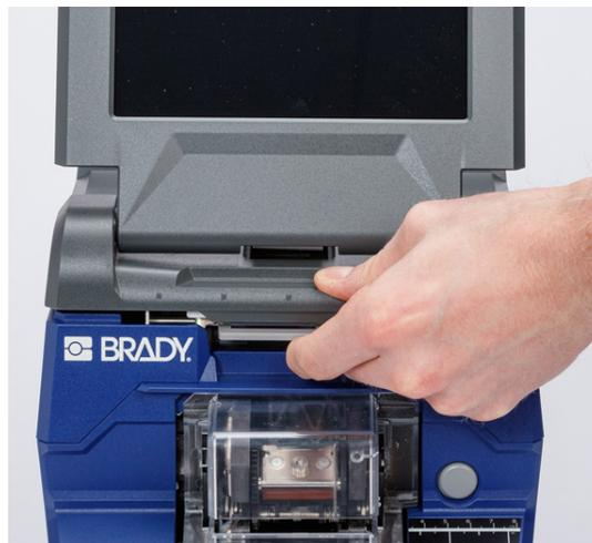
3. Entfernen Sie die vorhandene Etikettenrolle. (Bei Lieferung befindet sich Trägermaterial im Etikettenpfad. Achten Sie vor dem Entfernen auf die richtige Platzierung.)
