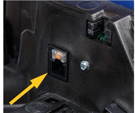
5. Reinigen Sie den **Sensor „Farbband leer“** im Druckergehäuse mit einem sauberen Wattestäbchen, das mit Isopropylalkohol befeuchtet wurde.
